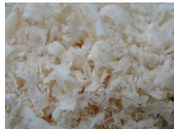
Deșeu din lemn pentru materialul compozit fonoabsorbant rumeguș de brad (stânga), rumeguș de fag (dreapta)
