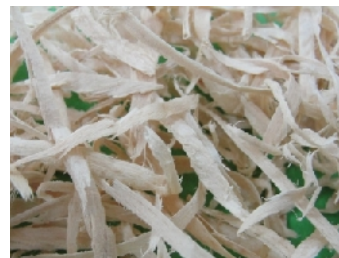
Deșeu din lemn pentru materialul compozit fonoabsorbant rumeguș de brad (stânga), rumeguș de fag (dreapta)
